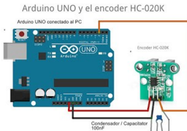
Esquema del encoder HC-020K, con un condensador y Arduino UNO.
